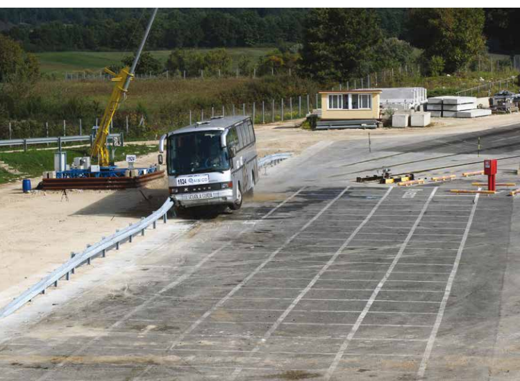
1. Un autobus rediretto a seguito dell'impatto con una barriera stradale
