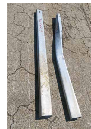
9. Il confronto tra due pali post urto dinamico con formazione della cerniera plastica (a destra) e senza formazione della cerniera plastica (a sinistra)
