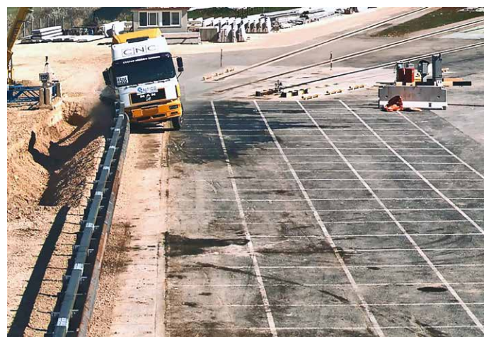
5. Un crash test sulla barriera oggetto dell'intervento
