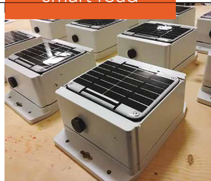
2A e 2B. WiseSensing è il sensore per monitoraggio strutturale di Wisepower, autoalimentato da vibrazioni ed energia solare
