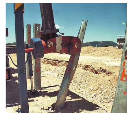
6A e 6B. La calibrazione del terreno del campo prove mediante prove dinamiche e simulazioni
