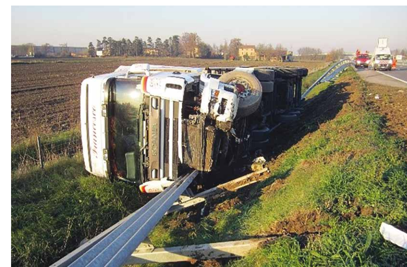
2A e 2B. Una barriera installata in situ (2A) e il suo comportamento in seguito a un impatto da parte di un veicolo (2B)
