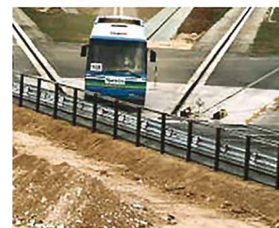
1A, 1B e 1C. La prima gamma di barriere stradali ANAS continue in un crash test su arginello ridotto (anno 2016)
