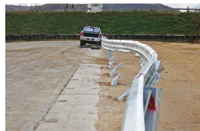
3A e 3B. Una barriera installata su terreno del Campo Prove (3A) e suo comportamento durante una prova di crash (3B)
