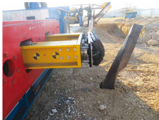
5A e 5B. La configurazione post-urto dinamico di un palo installato in sito (5A) e in campo prove (5B)
