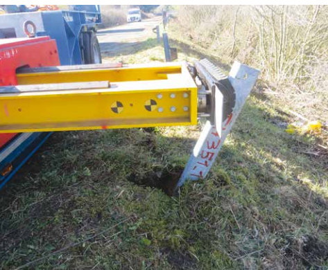
5A e 5B. La configurazione post-urto dinamico di un palo installato in sito (5A) e in campo prove (5B)
