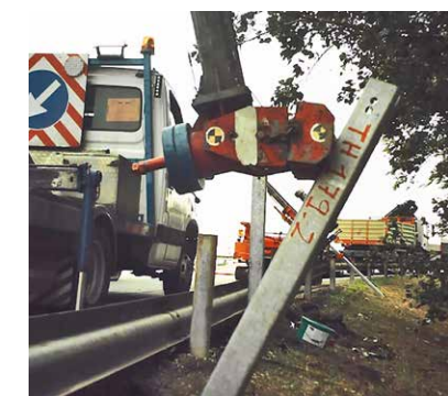
8A e 8B. La calibrazione del terreno in situ con S.C.Re.W.S. mediante prove dinamiche e simulazioni
