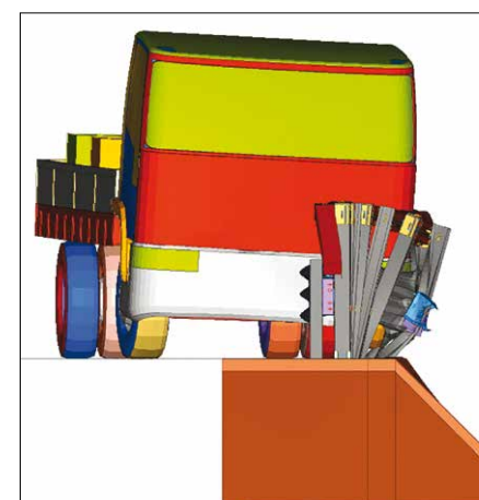
9. La simulazione del crash test con il terreno del campo prove
